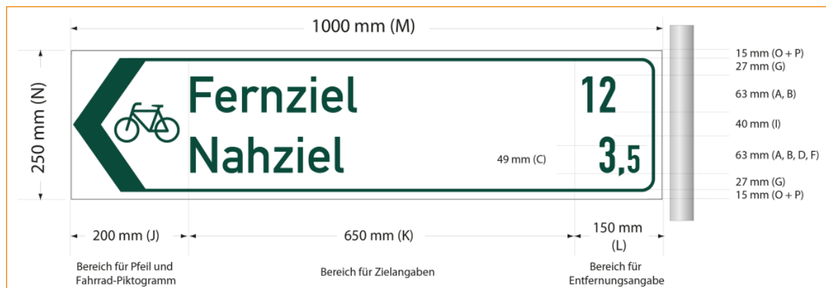
Abb. 10: Gestaltung und Bemaßung von Zielwegweisern (Beispiel)
